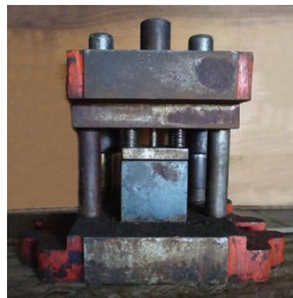
◀ Figure 9-32: Original Herschede Punch Press Die 13796
